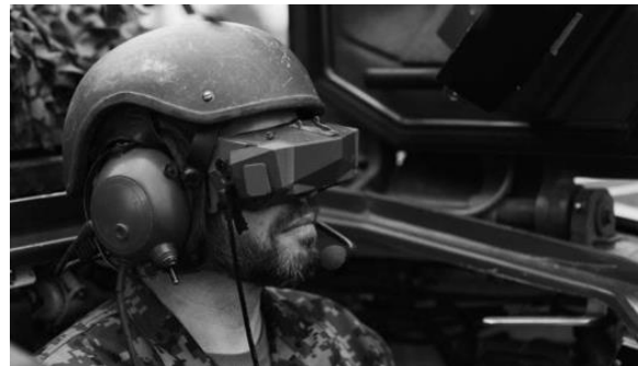
Helmviseur zur Verbesserung der Lageerkennung für gepanzerte Fahrzeuge des estnischen Herstellers Vegvisir
