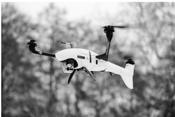
Aufklärungsdrohne des Typs Scorpion (short-range ISR multicopter sUAS) des deutschen Herstellers Quantum Systems
